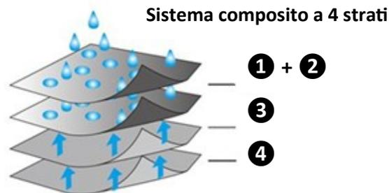
**① + ② Robusta doppia struttura esterna:** Il polipropilene estremamente resistente ai raggi UV e all'acqua, impressiona anche per la sua durabilità grazie al sistema composito doppio.
