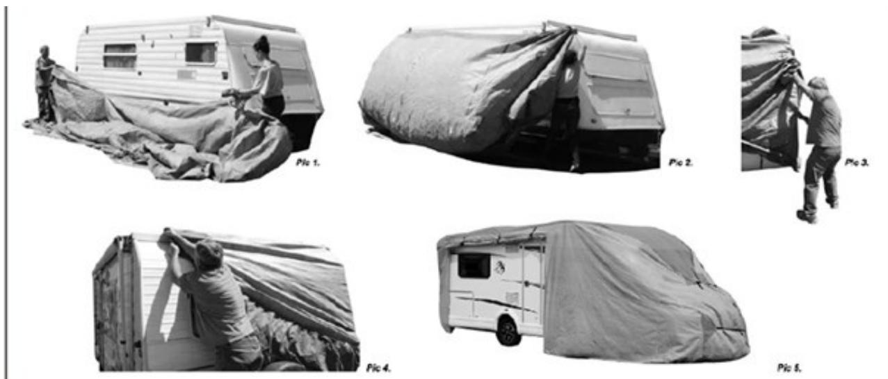
1. Posizionare la parte anteriore della copertura (secondo l'etichetta) all'anteriore della motorhome e tirare la copertura lungo il lato verso la parte posteriore.
